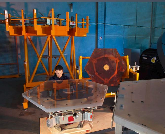
Segmentos experimentales del gigantesco espejo primario del E-ELT, sometido a pruebas.
